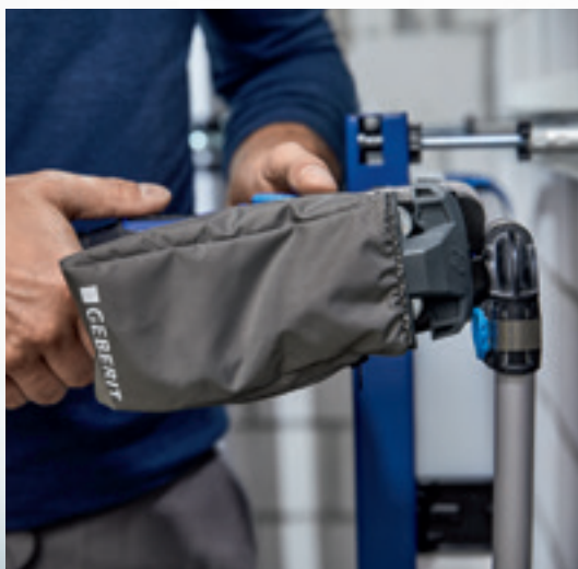
Podczas zaciskania z użyciem worka, wskaźniki są zbierane bezpośrednio do niego i mogą być przekazane do recyklingu.
